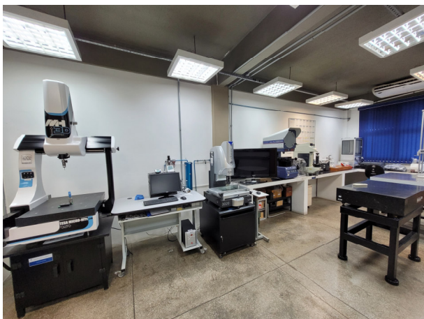
Metrologia [dimensional] – Realização de calibração em instrumentos de grandezas dimensionais, pressão, torque, força, massa, dureza e avaliação dimensional em peças pequenas.
